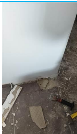
Matériaux : ZPSO-021 Prélèvement : P021 Description : Colle de carrelage Localisation : 1er étage - sdb Résultat : Absence d'amiante
