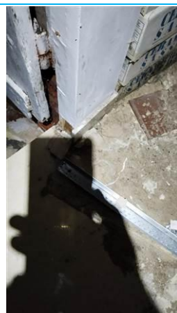
Matériaux : ZPSO-006 Prélèvement : P006 Description : Colle de plinthe Localisation : Rez de chaussée - entrée Résultat : Absence d'amiante
