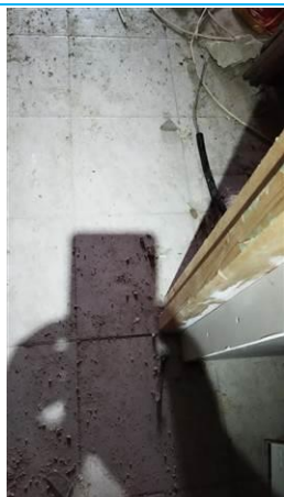
Matériaux : ZPSO-001 Prélèvement : P001 Description : Colle de carrelage Localisation : Rez de chaussée - cuisine 1 Résultat : Absence d'amiante
