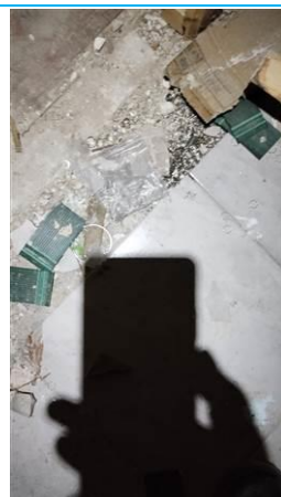
Matériaux : ZPSO-010 Prélèvement : P010 Description : Colle de carrelage Localisation : Rez de chaussée - ch 2 Résultat : Absence d'amiante
